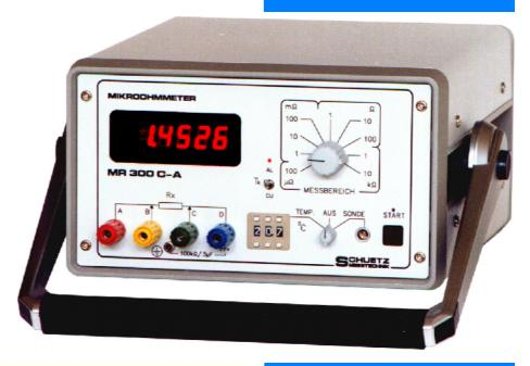
Erfolgt eine Temperaturerfassung, so wird der Meßwert über die Temperaturkoeffizienten für AL od. CU auf 20 °C umgerechnet und angezeigt.
